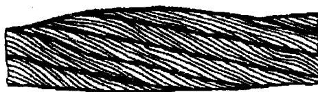
Рисунок 13. Местное увеличение диаметра каната
